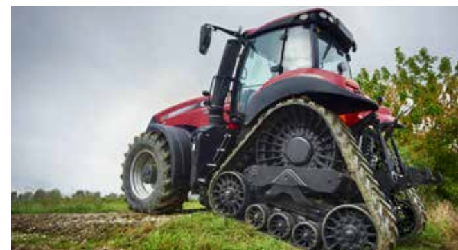
Koła i gąsienice utrzymują kontakt z podłożem, zapewniając maksymalną przyczepność.
