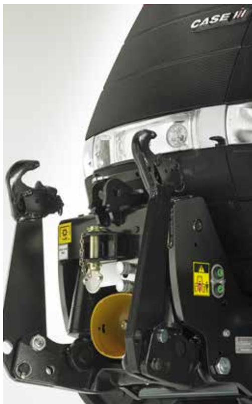
W pełni zintegrowany przedni zaczepek o udźwigu 5000 kg.
