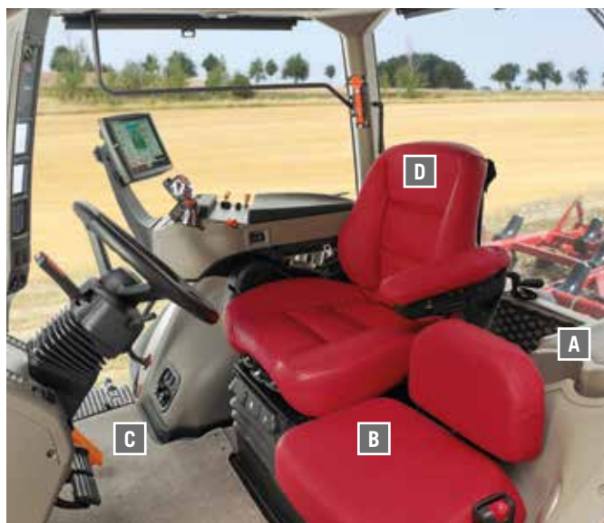
Komfort zapewniony przez półaktywny czerwony skórzany fotel z systemem dynamicznej amortyzacji, podgrzewanym i wentylowanym siedziskiem oraz automatycznym zawieszeniem.
