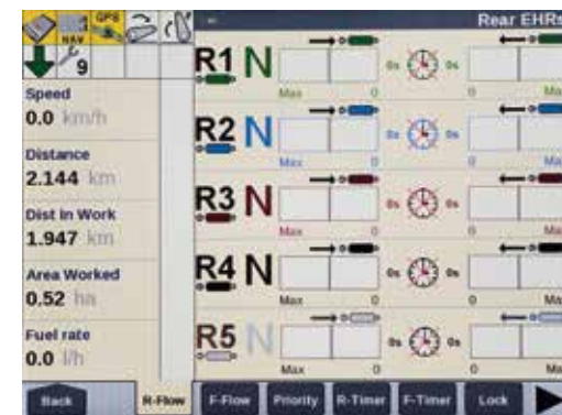
Natężenie przepływu i ustawienia regulatorów czasowych widoczne jednym rzutem oka na monitorze AFS Pro 700™.
